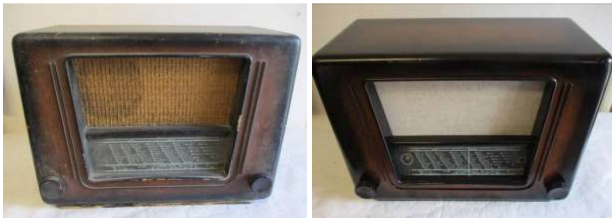
Rádioprijímač Kongres, nadobudnutý v roku 1949. Stav pred konzervovaním: poškodený, poškrábaný, bez zadného krytu. V rámci odborného ošetrovania bolo realizované vyčistenie rádiotechniky chemicky, skorodované časti mechanicky, konzervovanie
