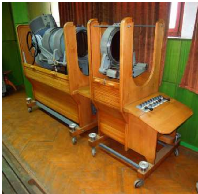
Fotoelasticimeter FMB 5 , experimentálne meracie zariadenie pre analýzu deformácií a napätí, Meopta n. p. Bratislava, 1950 – 1955, dar
