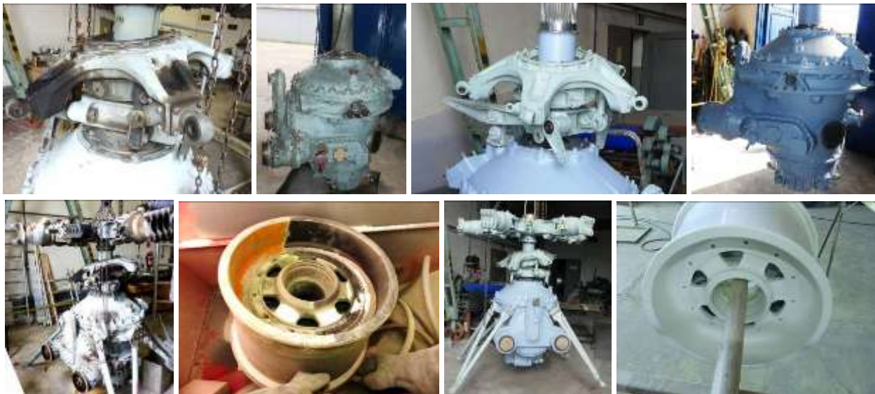
Vrtuľník Mi-8 PS-9 e.č. 2839, nadobudnutý v roku 2016 – etapovité reštaurovanie. Ukážky výsledkov reštaurovania častí reduktor a kolesá, vľavo stav pred a vpravo stav po ošetrovaní.
