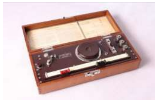
Prístroj na meranie odporu bleskozvodu , Ing. Erich Roučka, Blansko, 1925, výskum/vlastný zber
