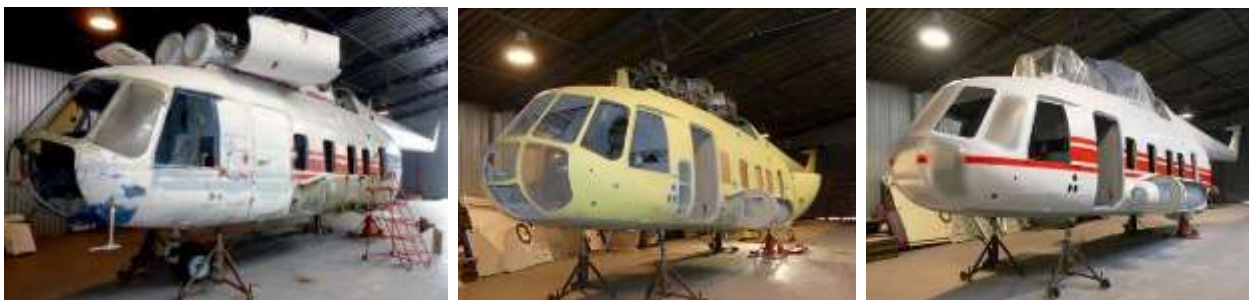
Vrtuľník MI-8 PS e. č. 2839, získaný darom v roku 2016. Vľavo stav pred ošetrovaním, v rámci etapovitého viacročného reštaurovania prebieha komplexné ošetrovanie stroja. Celkovo bolo zrealizované ošetrovanie 6 podskupín: hlavný reduktor; reduktor vyrovnávacieho rotora; požiarné kolektory a svetlomet a valec EKSR; brzdy a disky podvozku vrtuľníka; motorové kryty a sedačky a trupové kryty; nosná rotorová hlava. V závere roka 2020 bola zrealizovaná verná obnova nástreku vrtuľníka. Práce budú kontinuálne pokračovať v roku 2021 revitalizáciou palubného priestoru posádky.
